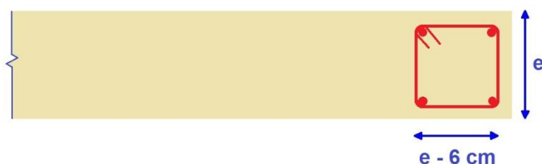
Figure 15 : Chainage sur les bords libres circulés
