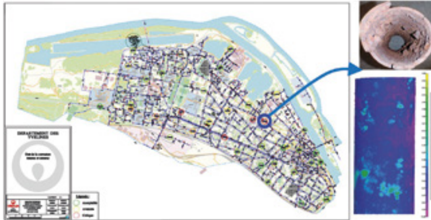
Figure 12 : Représentation de la perte d'épaisseur des conduites métalliques analysées et exemple de résultats (photographie d'une coupe transversale et répartition de l'épaisseur par profilométrie laser) – Veolia
