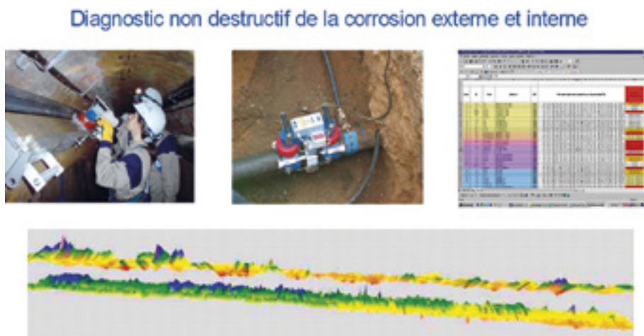
Figure 7 : Représentation de la perte d'épaisseur d'une canalisation métallique – mesure par MFL (Magnetic Flux Leakage) sans interruption de service – technologie SCANNER – Suez
