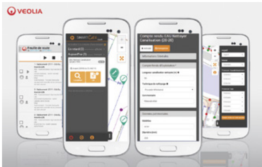
Figure 5 : Application de mobilité sur smartphone avec accès SIG et saisie des comptes-rendus d'intervention (Veolia, GISmartware)
