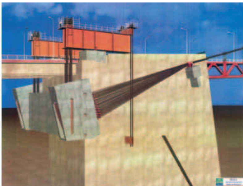
Figure 3 Vue d'ensemble du dispositif de hissage de poutre arrière rive gauche
