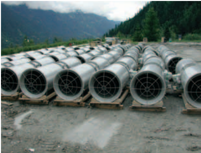
Photo 9 Soixante-seize accélérateurs longitudinaux
