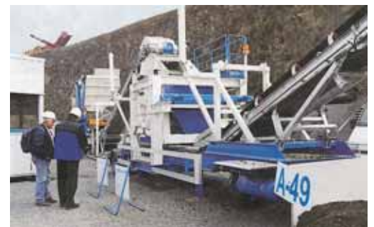
Benninghoven : Granulator combiné avec le broyeur à deux cylindres
