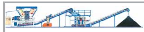
Benninghoven : schéma de l'installation Granulator, fraise, bande transporteuse, séparateur magnétique, crible, broyeur à deux cylindres
