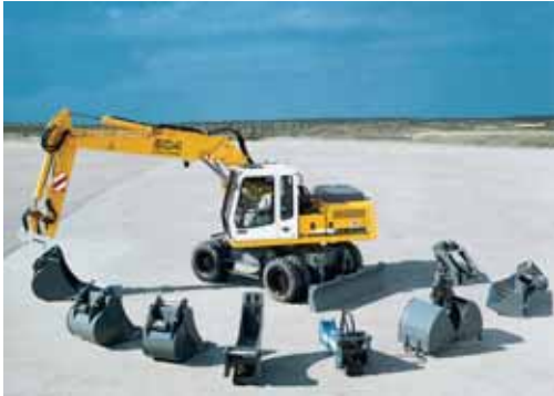
Liebherr : système de chargement rapide Likufix
