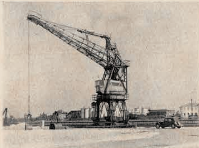
Fig. 9. — La nouvelle grue électrique (portée variable de 6 à 18 m; force de levage : 10 à 3 t).
