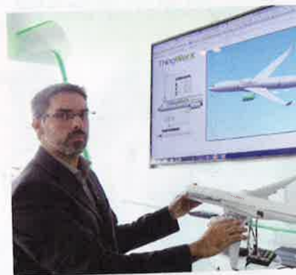
Sur cet écran, le jumeau numérique réagit en temps réel aux actions effectuées sur le modèle réduit de l'avion équipé de capteurs.
